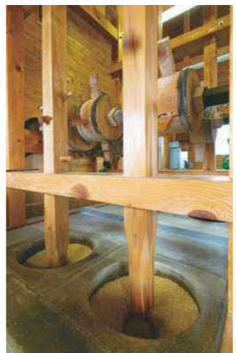
全国でも珍しい杵つき精米機。モーターの動力で歯車が回る仕組みになっている
