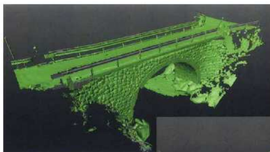
下町橋 3D レーザー計測成果
