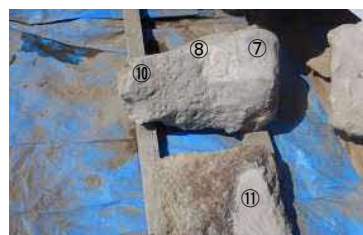
写真-4 石材に実施の擬石サンプル
