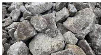
流用中詰め材:材質(地元の加久藤石)
