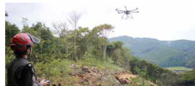
▲ドローンを使い、シカの食害防護柵の材料を運搬
