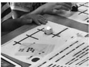
線の上を走り、色の組み合わせで進む方向が変わるロボット
